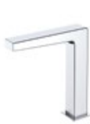
TLE25007E Automatikarmaturen- auslauf, eckig, mittelhoch, 2l/min, Ausladung 139mm Autofaucet square, medium high, 2l/min, projection 139mm
